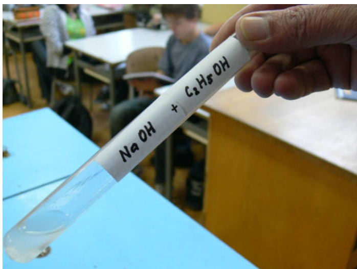
Jodoformová zkouška – důkaz ethanolu
